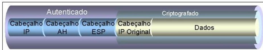
Figura 2: Estrutura do Pacote IPSec. Fonte: Barbosa (2004).
