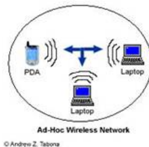
Figura 2 - Rede sem fio com configuração Ad-Hoc
